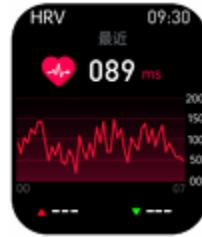
Bezeichnet die Herzfrequenzvariabilität und misst das Zeitintervall zwischen den Herzschlägen. Die Uhr erstellt automatisch einen Bericht, der auf der Uhr und in der App angezeigt werden kann.
